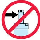
Der integrierte IMA-S-Motorantrieb ist nicht für Anwendungen vorgesehen, bei denen eine Seitenkraft auftritt. Lasten müssen geführt und gestützt werden. Lasten müssen entlang der Bewegungslinie der Kolbenstange ausgerichtet werden. Seitenkräfte beeinflussen die Lebensdauer des Antriebs.
